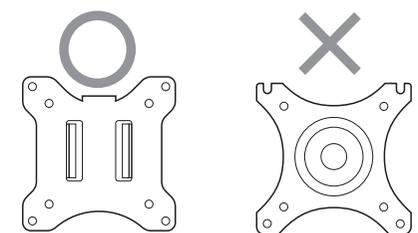
※VESA取付け穴ピッチに合わせて下図の向きに変換ブラケットを取付けます。
