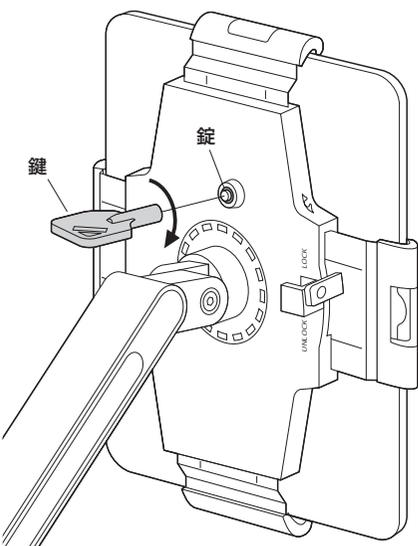
① ホルダーのレバーを矢印の方向へスライドし、ロックを解除します。
