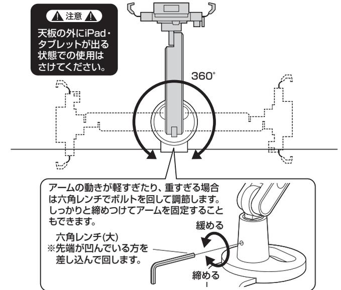
アームの動きが軽すぎたり、重すぎる場合は六角レンチでボルトを回して調節します。しっかりと締めつけてアームを固定することもできます。
