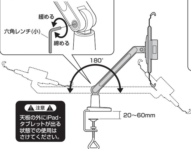
アームの動きが軽すぎたり、重すぎる場合は六角レンチでボルトを回して調節します。
