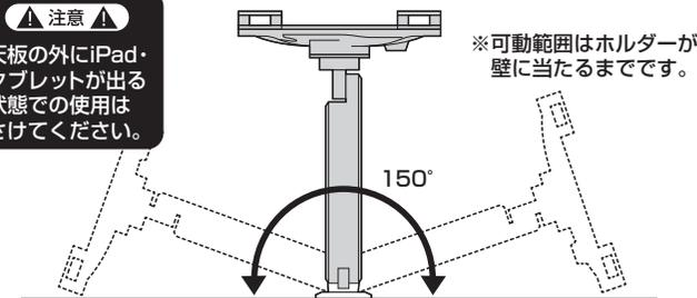
アームの動きが軽すぎたり、重すぎる場合は六角レンチ(大)でボルトを回して調節します。しっかりと締めつけてアームを固定することもできます。
