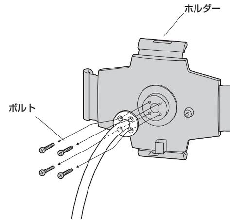
②支柱に付いているボルトを締め付けます。
