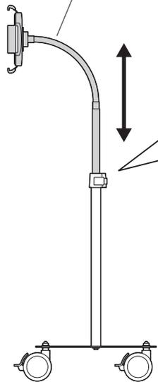
レバーのロックを解除し、支柱の高さを調節します。
