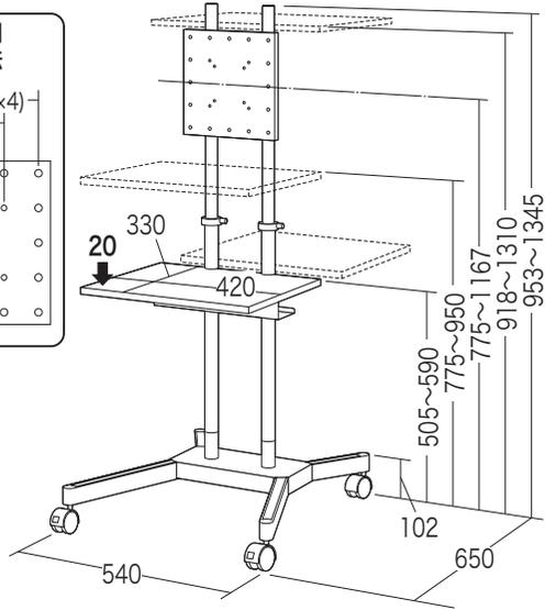
総耐荷重 60kg (40kg以下のテレビを取付け可能)
