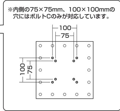
**▲注意▲** ボルトが長すぎるとディスプレイを破損する場合があります。また、ボルトが短すぎるとディスプレイがしっかりと固定できず脱落する恐れがあります。取付けに適したボルトの長さは各ディスプレイによって異なります。必ずディスプレイの取扱説明書や、メーカーへの問い合わせなどでご確認の上、取付けるボルトの長さを決めてください。
