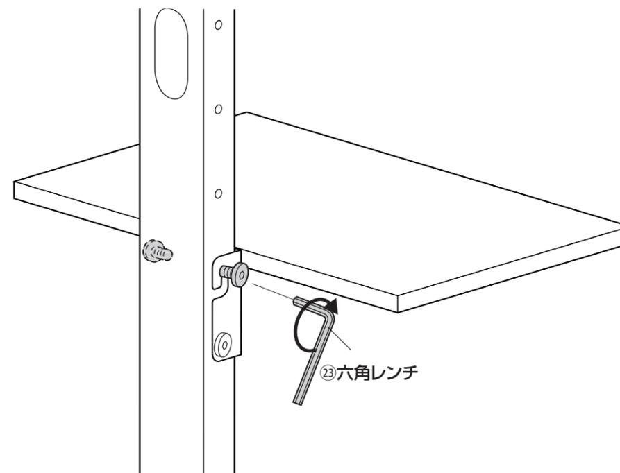
**9** カメラ台ブラケットにカメラトレーを取付けます。
