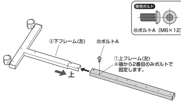
※同様に下フレーム(右)にも上フレーム(右)を取付けます。
