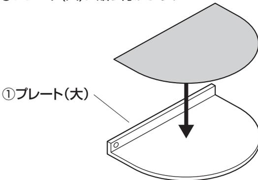
**② 天板をプレートではさんだ状態でモニターアームのクランプを取付けます。**
