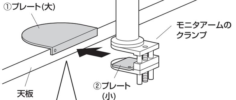
天板をプレートではさんだ状態でクランプを取付けます。
