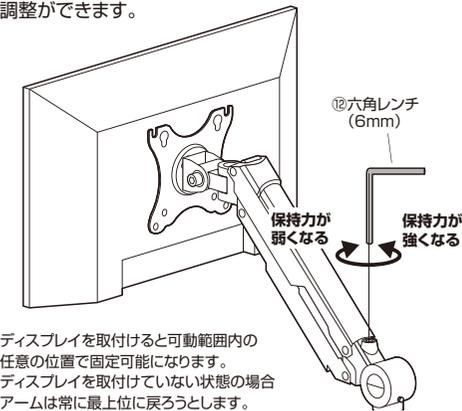
ディスプレイを取付けると可動範囲内の任意の位置で固定可能になります。ディスプレイを取付けていない状態の場合アームは常に最上位に戻ろうとします。
