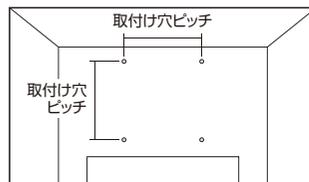
取付け穴ピッチが **75×75mm**の場合は **手順6のAへ**
