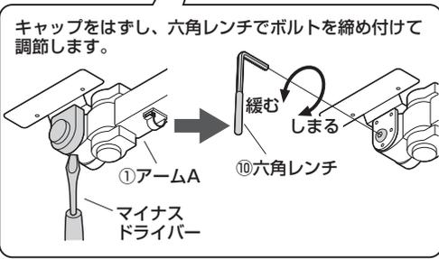
キャップをはずし、六角レンチでボルトを締め付けて調節します。
