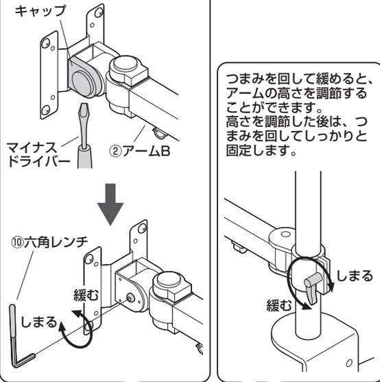
つまみを回して緩めると、アームの高さを調節することができます。高さを調節した後は、つまみを回してしっかりと固定します。
