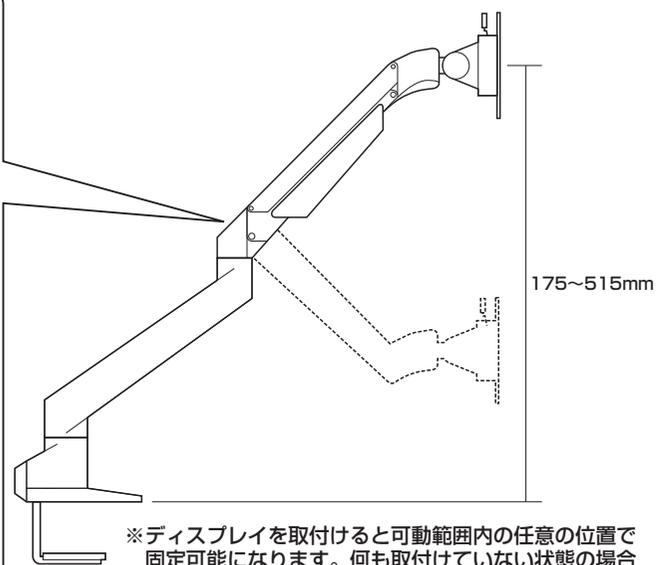
※ディスプレイを取付けると可動範囲内の任意の位置で固定可能になります。何も取付けていない状態の場合アームは常に最上位に戻ろうとします。
