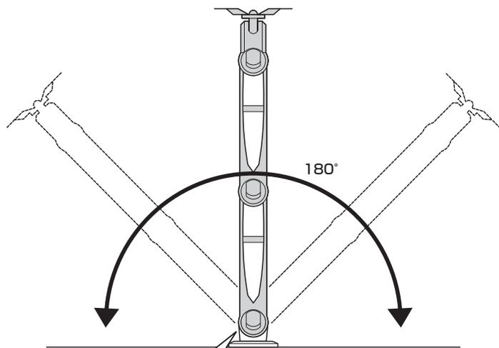
アームの動きが軽すぎたり、重すぎる場合は六角レンチでボルトを回して調節します。
