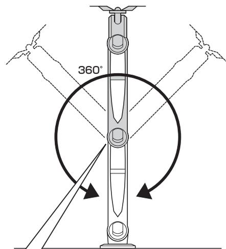
アームの動きが軽すぎたり、重すぎる場合は六角レンチでボルトを回して調節します。
