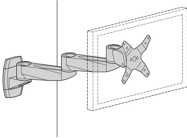
総耐荷重 15kg (15kg以下のディスプレイを取付け可能)
