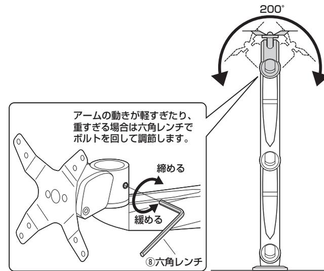
アームの動きが軽すぎたり、重すぎる場合は六角レンチでボルトを回して調節します。
