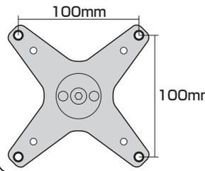
**▲ 注意 ▲** ボルトが長すぎるとディスプレイを破損する場合があります。また、ボルトが短すぎるとディスプレイがしっかりと固定できず脱落する恐れがあります。取付けに適したボルトの長さは各ディスプレイによって異なります。必ずディスプレイの取扱説明書や、メーカーへの問い合わせなどでご確認の上、取付けるボルトの長さを決めてください。
