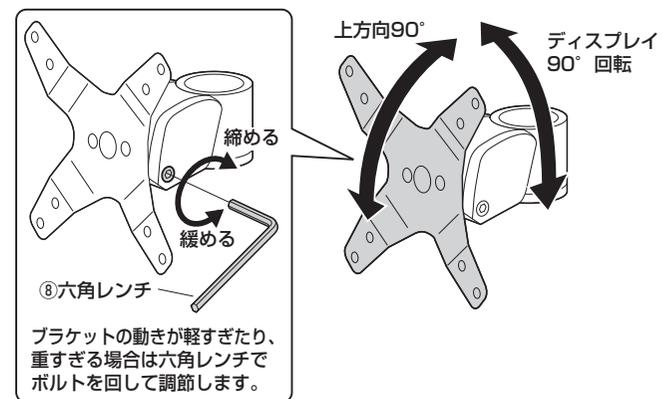
ブラケットの動きが軽すぎたり、重すぎる場合は六角レンチでボルトを回して調節します。
