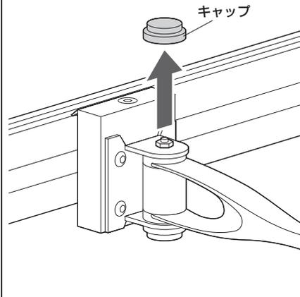
②ナットを回して固さを調節します。
