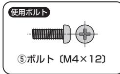
※付属のボルトが最後まで締まらない、またボルトが少ししか回っていないなど、ボルトが合わない場合は、強度に十分ご注意ください。市販の適切なサイズのボルトをご用意ください。
