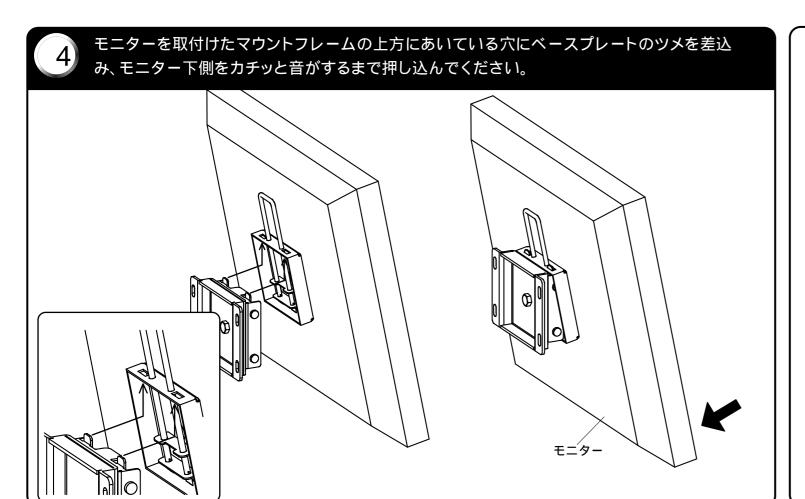
モニターは自由に回りますが、堅かたり緩かったりした場合はモニターをはずし、ベースプレート側のナットを付属のスパナで回して調整してください。
