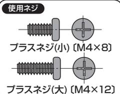
※ディスプレイ後ろ面のネジ穴を利用し、ブラケットに取付けます。
