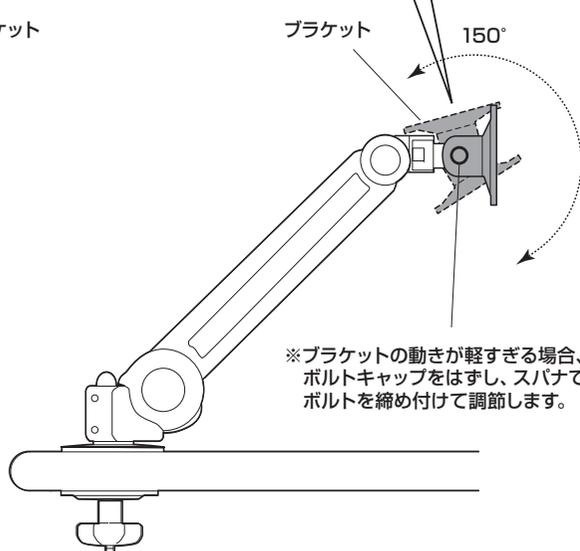
※ブラケットの動きが軽すぎる場合、ボルトキャップをはずし、スパナでボルトを締め付けて調節します。
