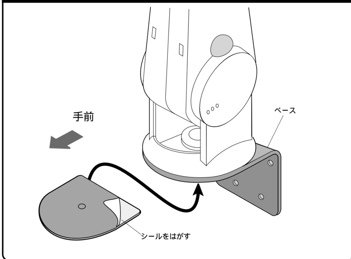
2 シールを貼り付けたベースと、クランプ上面で机をはさみこみ、クランプとベースを六角穴付ボルトで取り付けます。この時ボルトは2個以上使用して下さい。
