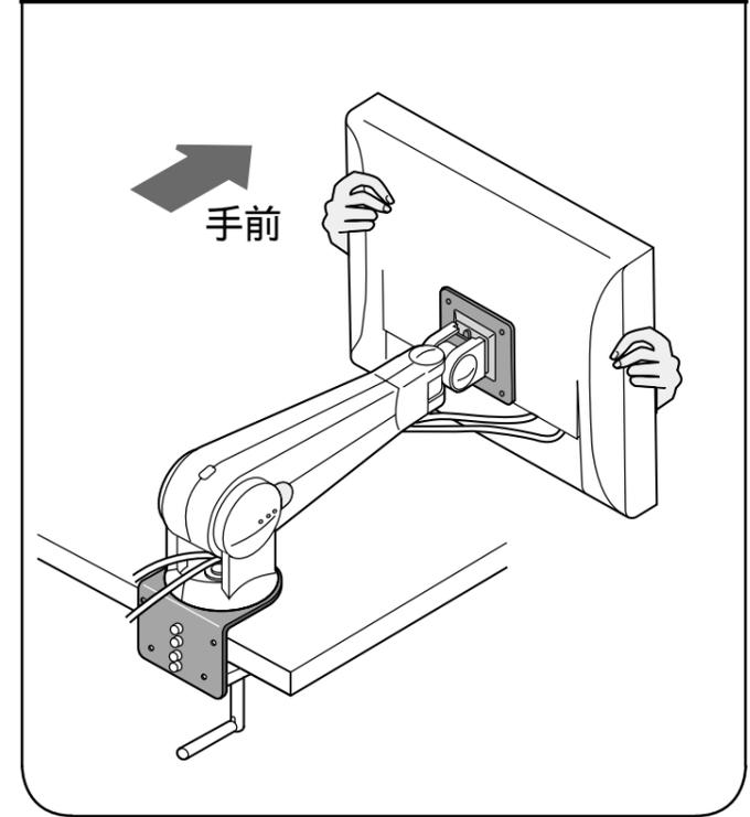
LCDモニタは4つのボルトでしっかりと固定してください。
