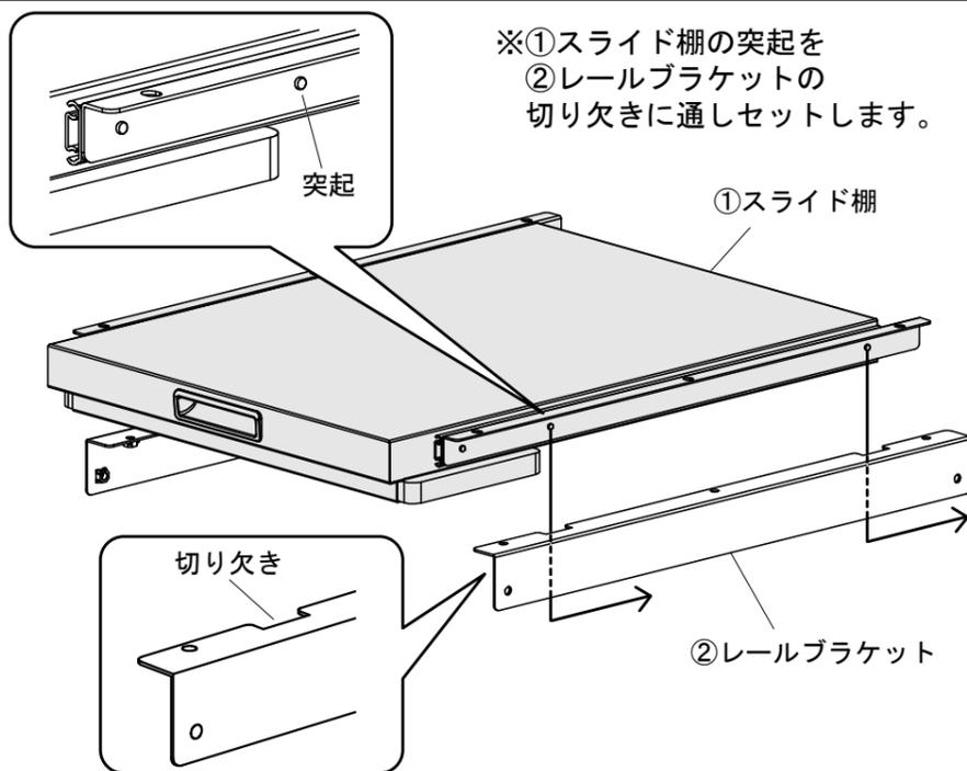
4 スライド棚とレールブラケットをボルトで取付けます。
