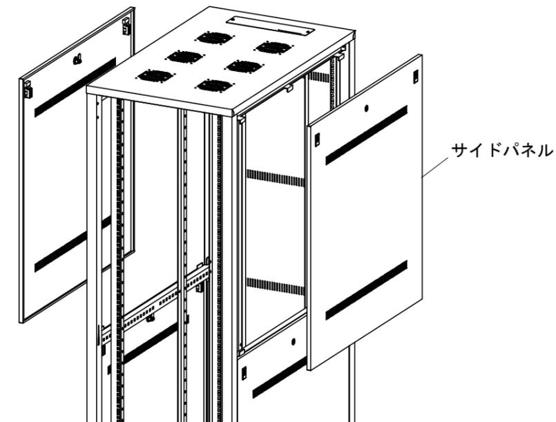
2 任意の高さにレールブラケットを外側からボルトで支柱に取付けます。
