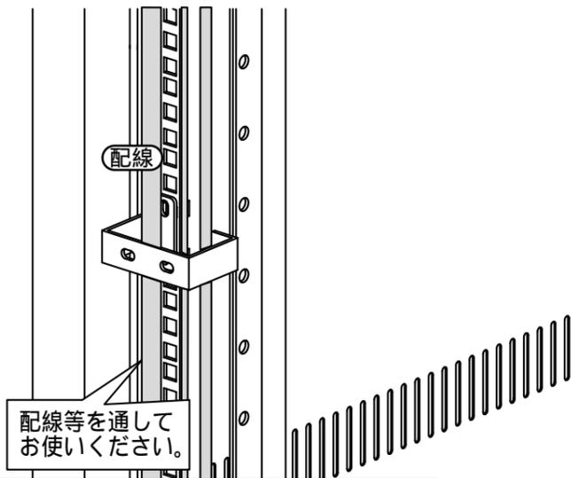
マウントフレームは取付け穴の2番目以降に取付けて下さい。
