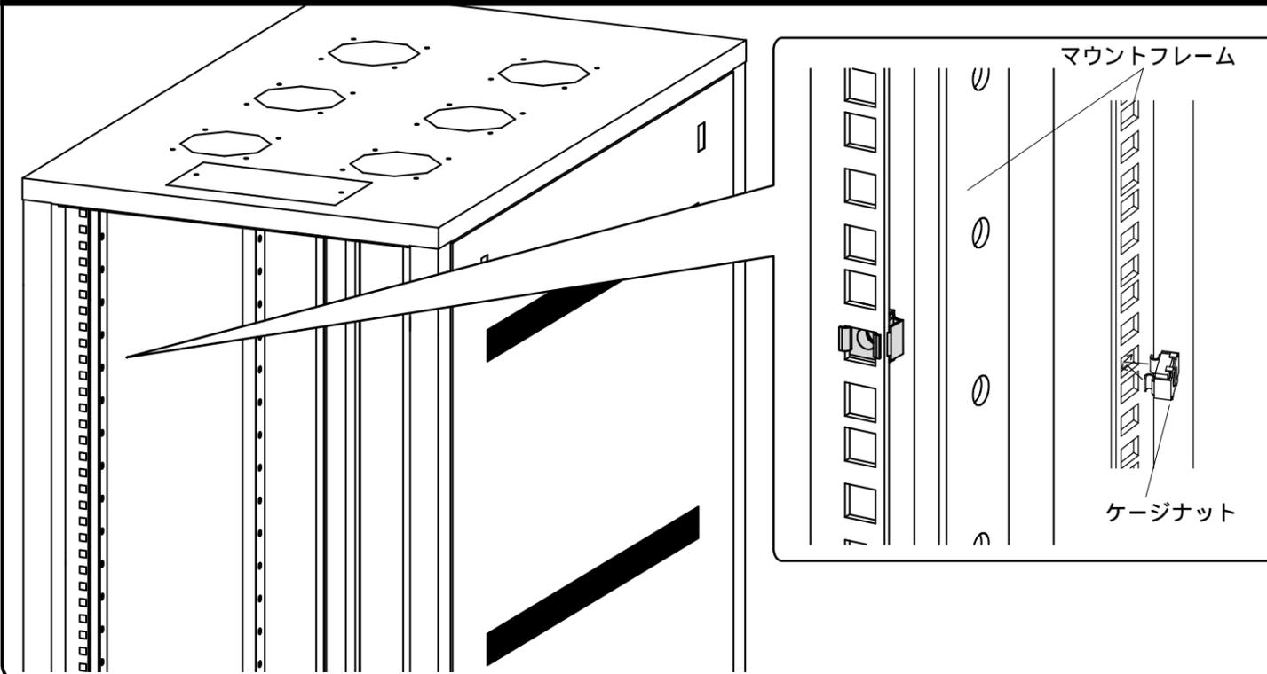
2 で取付けたケージナットにスクリュ、台座を使ってフックを取付けて完成です。
