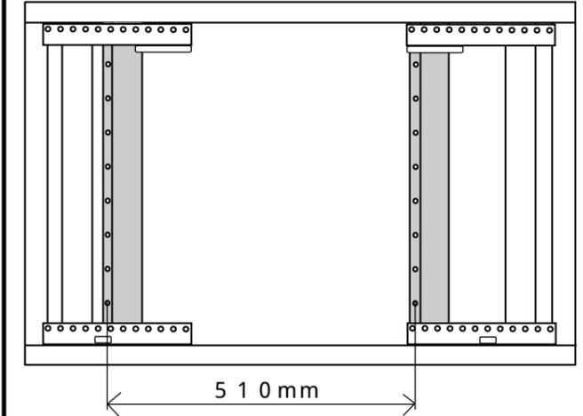
取付支柱の間隔は、510mmで取り付けられています。
