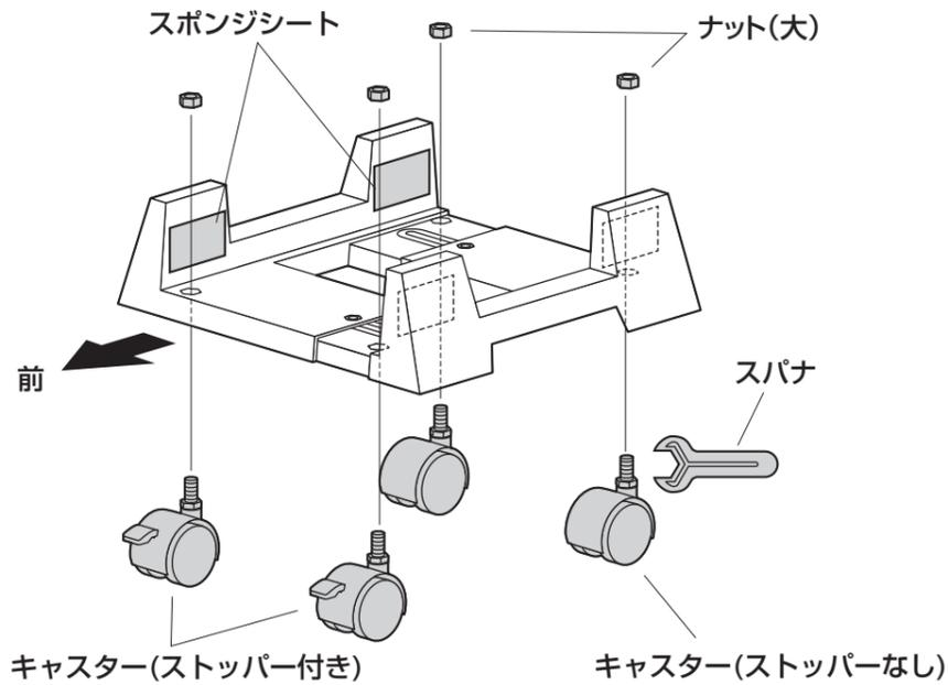
3 PCの上面に逆さにのせ、サイドフレームの幅を合わせてから固定します。
