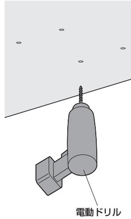
③天井に天井取付け金具を取付けます。
