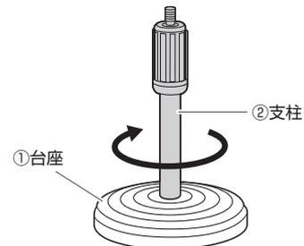
(2) 固定台を支柱のネジに回して固定します。
