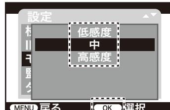
何も動きがないのにセンサーが動作し撮影されている場合は「低感度」に設定してください。
