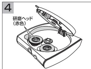
回転が止まった後にオープンボタンを押し、上蓋を開けます。ディスクのデータ面に研磨跡が残りますが再生時に支障はありません。ディスクを取り出し、研磨ヘッド(赤色)を取り外します。
