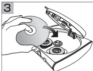
傷ついたディスクのデータ面(光沢面)を下向きにカチッと音がするまでセットし、上蓋を閉めます。(ヘッドに接触するように)スタートボタンを押すと自動的に回転が始まります。約2分間で自動的に回転が止まります。
