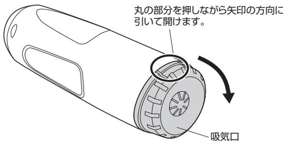
②フィルターを外し、フィルターに付着したホコリなどを取除きます。
