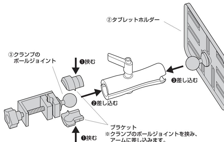
**4** レバーを矢印の方向に回し、締め付けて固定します。
