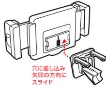
車のエアコンのフィンにクリップを引っ掛け取付けます。
