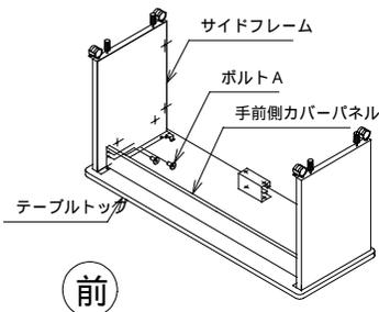
4 サイドフレーム（左右）後側に扉付フロントパネルをボルトAで取付けます。この時、扉はテーブルトップ側にくるように取付けてください。
