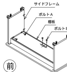
2 サイドフレーム（左右）に手前側カバーパネルをボルトAで取付けます。この時、手前側カバーパネルをテーブルトップ側に押し付けて締め付けてください。
