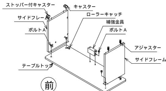
3 サイドフレーム（左右）に棚板をボルトAで取付けます。この時、棚板の150×30長丸が後側にくるように取付けてください。
