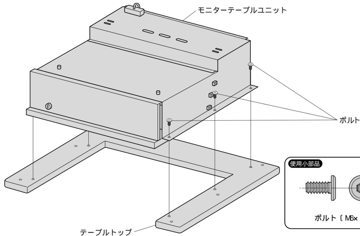
2 サイドフレームをボルトで取り付けます。(6ヶ所)
