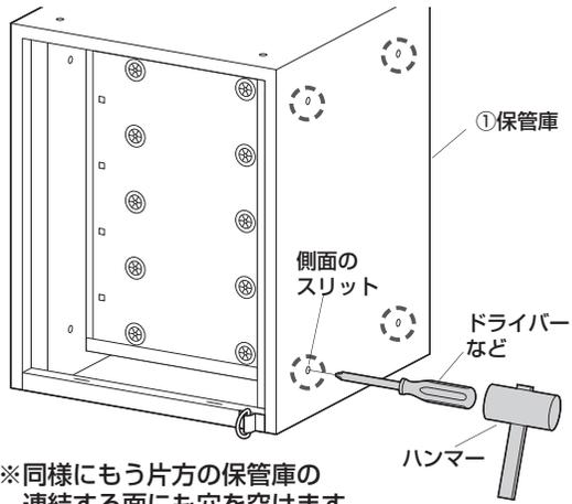
※同様にもう片方の保管庫の連結する面にも穴を開けます。
