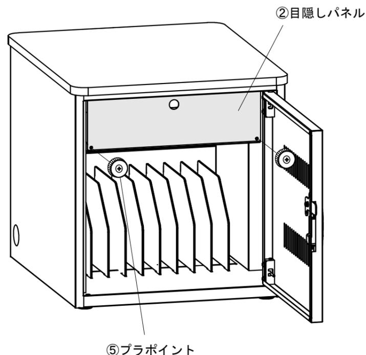
バックパネルの取外し方
