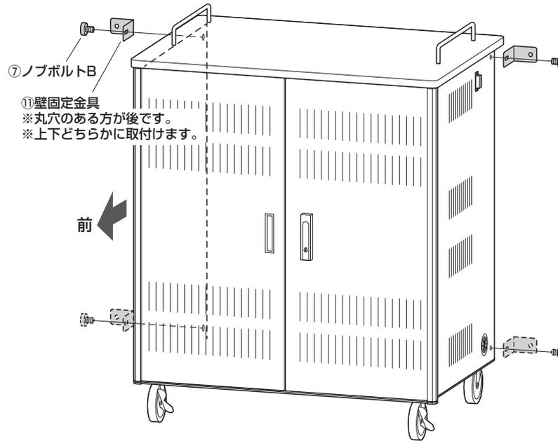
②キャビネット本体を固定する場所に移動し、壁固定金具の穴位置に鉛筆などで印を付けます。
