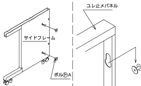
③ボルトAを締め込むとユレ止メパネルが取り付けます。
