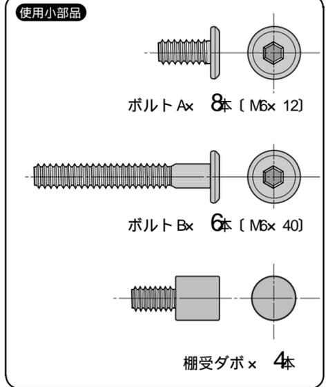
1 デスクの高さを決定し、フレームをボルトAでゆるめに取り付けます。
