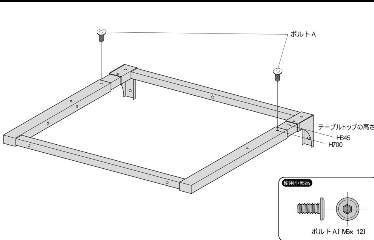
2 テーブルトップを裏側にし、フレームをボルトAとBで、ゆるめに取り付けます。フレームにストッパー付きキャスターを前に、キャスターを後に取り付けます。
