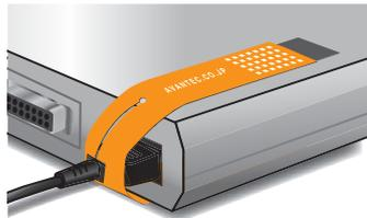
③ プラグ側から、ケーブル固定用面ファスナー(黒)のスリット部をプラグの上からスライドするように入れ、ケーブル引掛用面ファスナーに取付けてケーブルを固定します。
