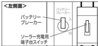
6. ソーラー充電用接続端子台のスイッチをON(上側)にします。
