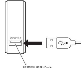
2 機器を接続し、出力ボタンを押すと充電を開始します。(充電中は出力ランプが点滅します)
