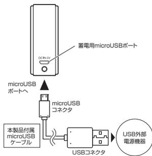
2 蓄電中は、本製品の電池残量目安の数値の1桁目が点滅動作し数値が増えていきます。
