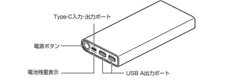
※電源ボタンを押すと、電池残量目安のLEDが点灯し、電池残量を確認することができます。
