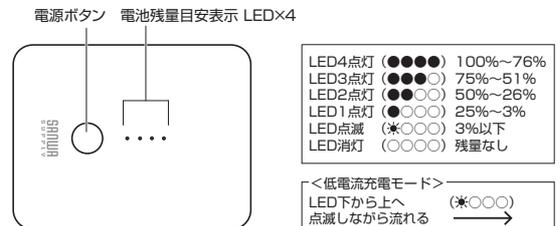
※電源ボタンを2回押しすると、LEDが下から上へ点滅しながら流れ、低電流充電モードが有効になります。
