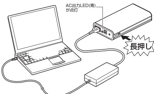
※使用後は必ず電源ボタンを長押しして本製品の電源をOFFにしてください。
