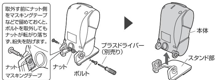
② 本体のスキャン部を上に向け、ボルトとナットでスタンド部に取付け、接続ケーブルを取付けてください。
