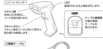
RJ-45コネクタ コードリーダーの ケーブル接続部に 取付けます。
