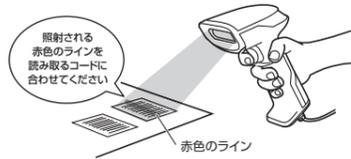
スキャン部をコードに向けてスキャンボタンを押します。LEDが照射されてピープ音が鳴り、コードが読み取られます。
