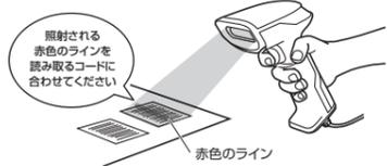
スキャン部をコードに向けてスキャンボタンを押します。LEDが照射されてピープ音が鳴り、コードが読み取られます。※読み取られるまでスキャンボタンを押し続けてください。
