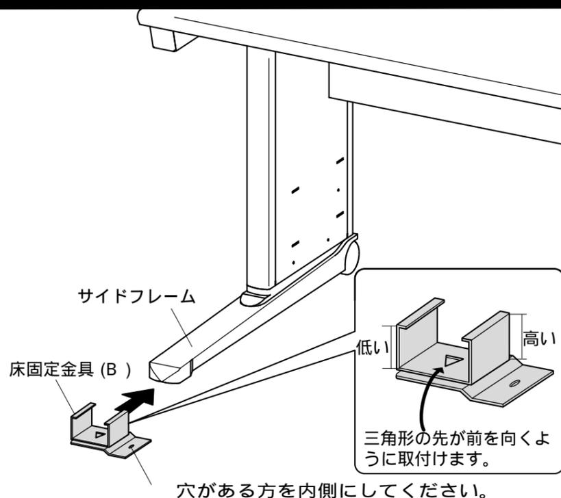
3 サイドフレームに床固定金具 (A) をアジャスターで取付けます。
