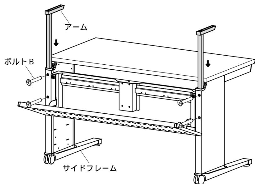
3 アームにサブテーブルをのせボルト A で固定します。
