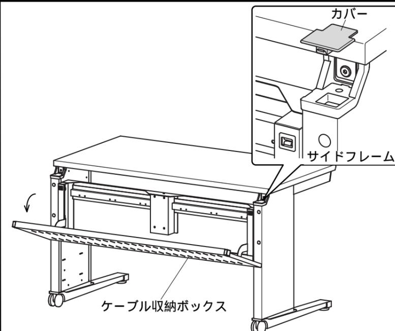
2 サイドフレームにアームを差込み任意の位置でボルト B を使い固定します。
