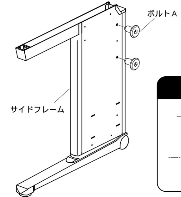
2 ケーブルボックスのたるま穴にサイドフレームのボルト A を差込み押し下げます。ボルト A を締め付けます。
