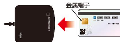
ICカードが挿入され、正しく認識されるとLEDは点灯状態になります。認識後、点滅状態になります。
