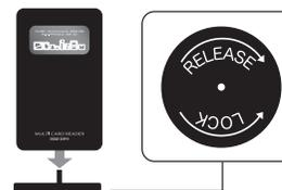
LOCKの方向に回して取付けます。
